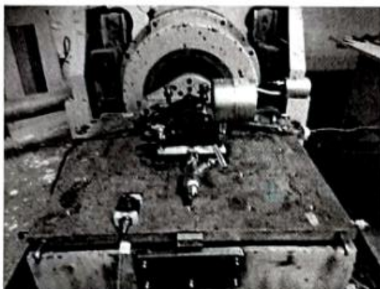
25. 样品 SB2300382、LB2300002 耐工作环境振动性能、耐冲击性能 (Y 方向) 试验照片
