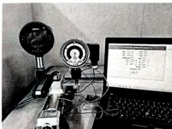
9. 样品 LB2300002 电信号基本误差、回差试验照片
