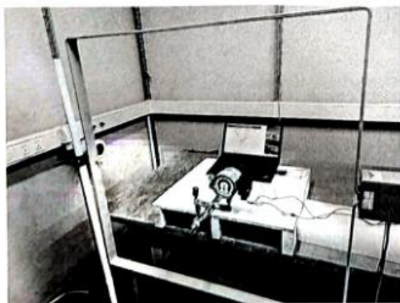
23. 样品 LB2300002 工频磁场试验照片
