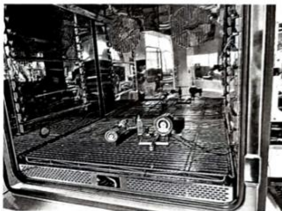
10. 样品 SB2300382、LB2300002 温度补偿、温度循环试验照片
