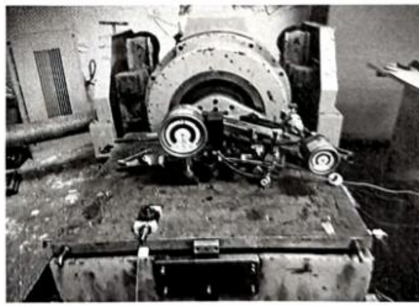
24. 样品 SB2300382、LB2300002 耐工作环境振动性能、耐冲击性能 (X 方向) 试验照片
