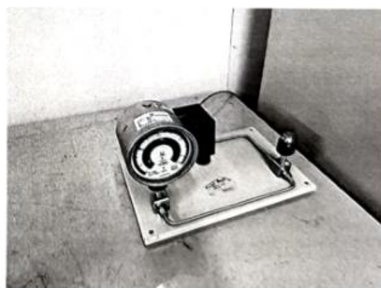
6. 样品 LB2300002 基本误差、回差、指针偏转平稳性、轻敲位移、静压试验照片
