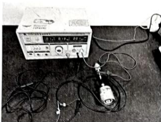
13. 样品 SB2300382 绝缘性能 (绝缘强度) 试验照片
