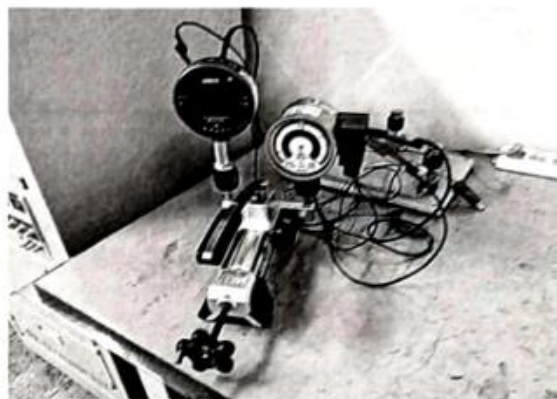
8. 样品 LB2300002 设定点偏差、切换差试验照片
